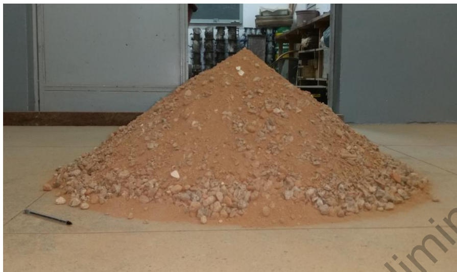
Figura 1: Mistura de solo com RCC.
