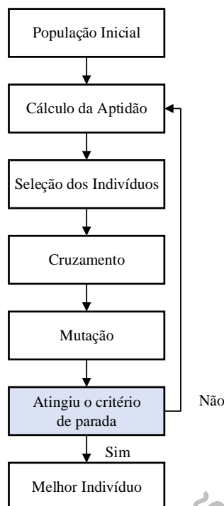
Figura 3: Estrutura de um Algoritmo Genético
