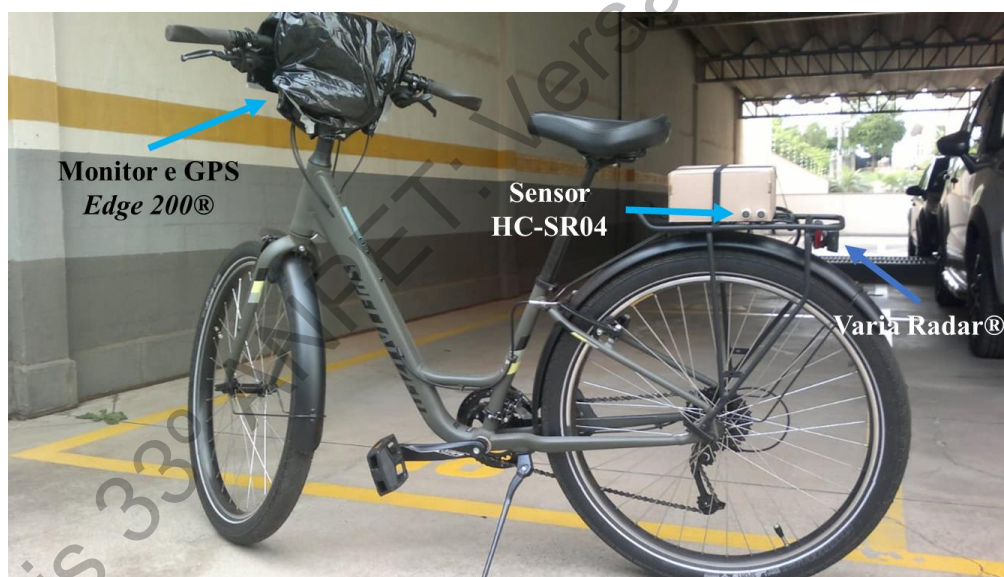
Figura 2: Bicicleta com equipamentos embarcados
