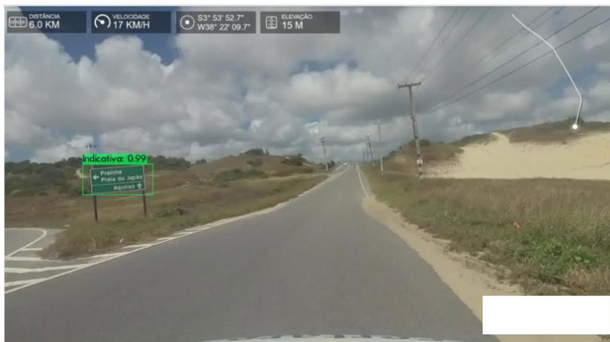
**Figura 8:** Placa indicativa identificada automaticamente utilizando-se o Modelo Yolov3-416x416 – 5000 iterações.
