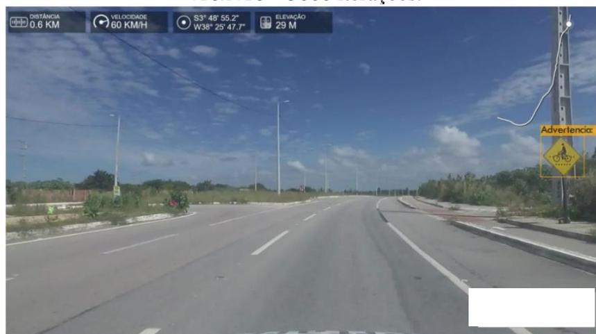
**Figura 7:** Placa de advertência identificada automaticamente utilizando-se o Modelo Yolov3-416x416 – 5000 iterações.
