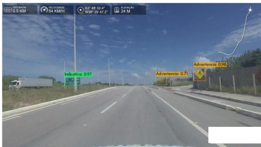
**Figura 9:** Sinalização vertical identificada automaticamente utilizando-se o Modelo Yolov3-416x416 – 5000 iterações.
