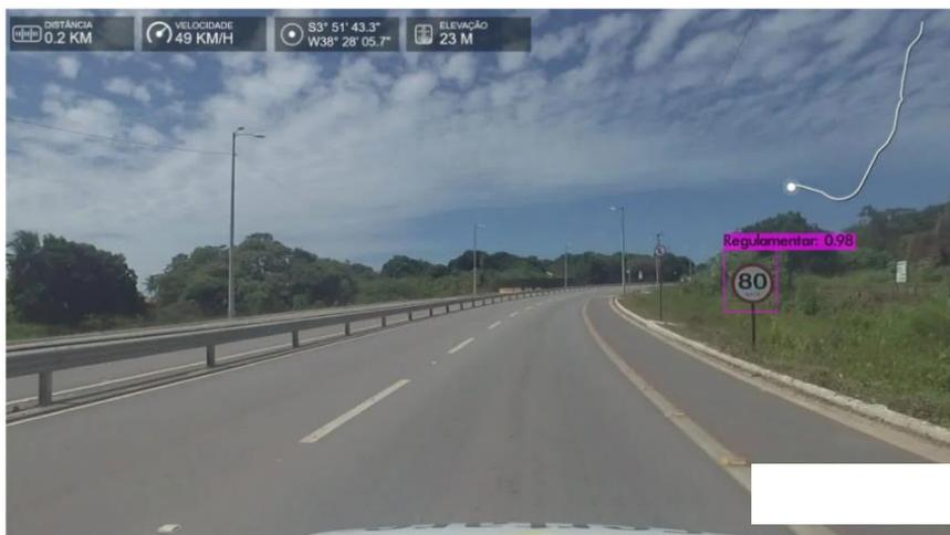
**Figura 6:** Placa regulamentar identificada automaticamente utilizando-se o Modelo Yolov3-416x416 – 5000 iterações.
